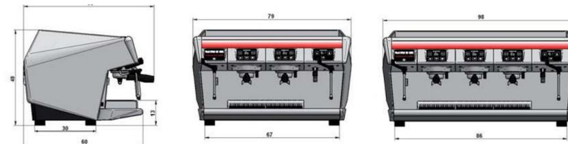
La Stella di Caffè est disponible en deux versions : STANDARD (STD) ou VOLUME + (V+). La Stella di Caffè VOLUME + autorise une hauteur de tasses jusqu'à 18 cm, pouvant être réduit à 10.5 cm ou 8 cm grâce à un système de grilles repliables et positionnables à différents niveaux.
